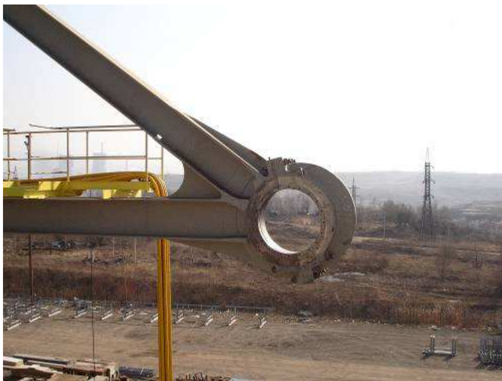
Obr.7- Ložiskový domek – strana pohonu-pohled zadní
