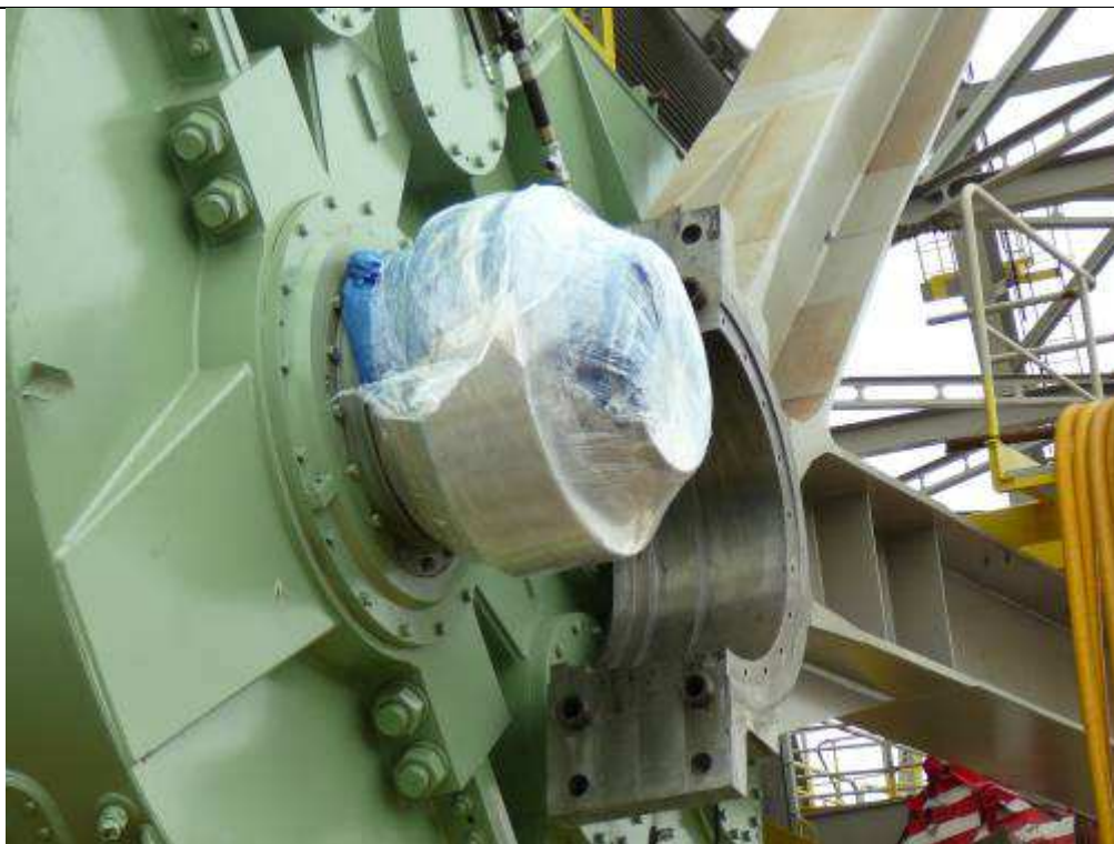
Obr.17-ložisko po montáži (strana A)
