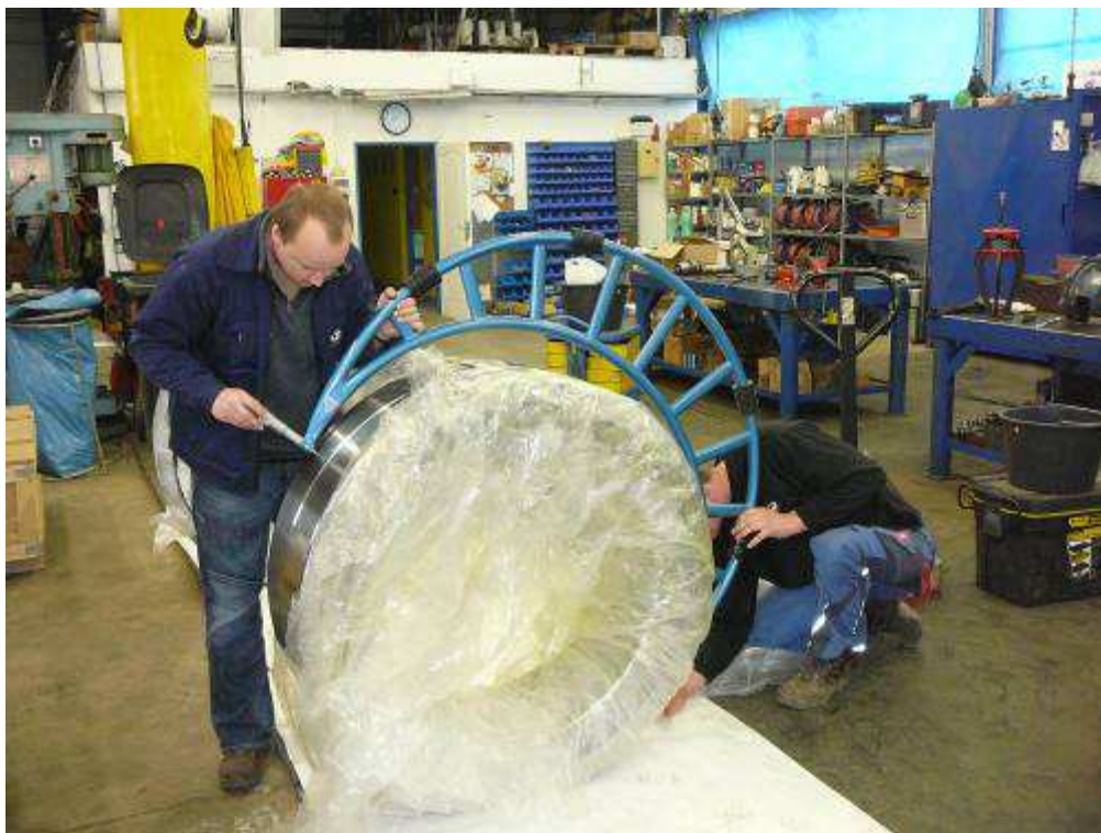
Obr.11 – kontrola průměru ložiska a radiální vůle
